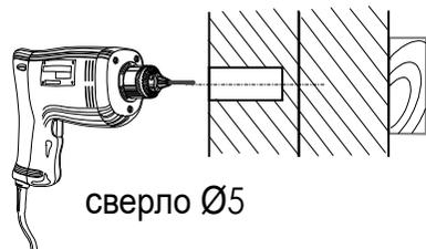
На этом этапе сборки необходимо доработать отверстия "X", предназначенные для соединения изделий между собой.
